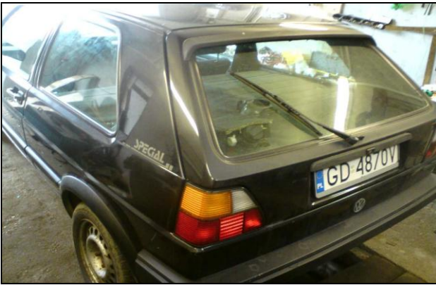
Rys. 7. Tył samochodu Duomoto z widokiem na pokrywą wygłuszającą komory tylnego zespolonego układu napędowego [6].
