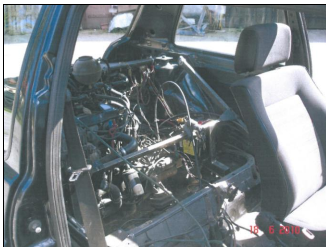
Rys. 6. Silnik wraz z zespolonym układem napędowym zamontowany w tylnej części nadwozia samochodu Duomoto [5],
