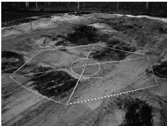
Rys. 4. Kolumna badana w otoczeniu sześciu kolumn wzmocniających
