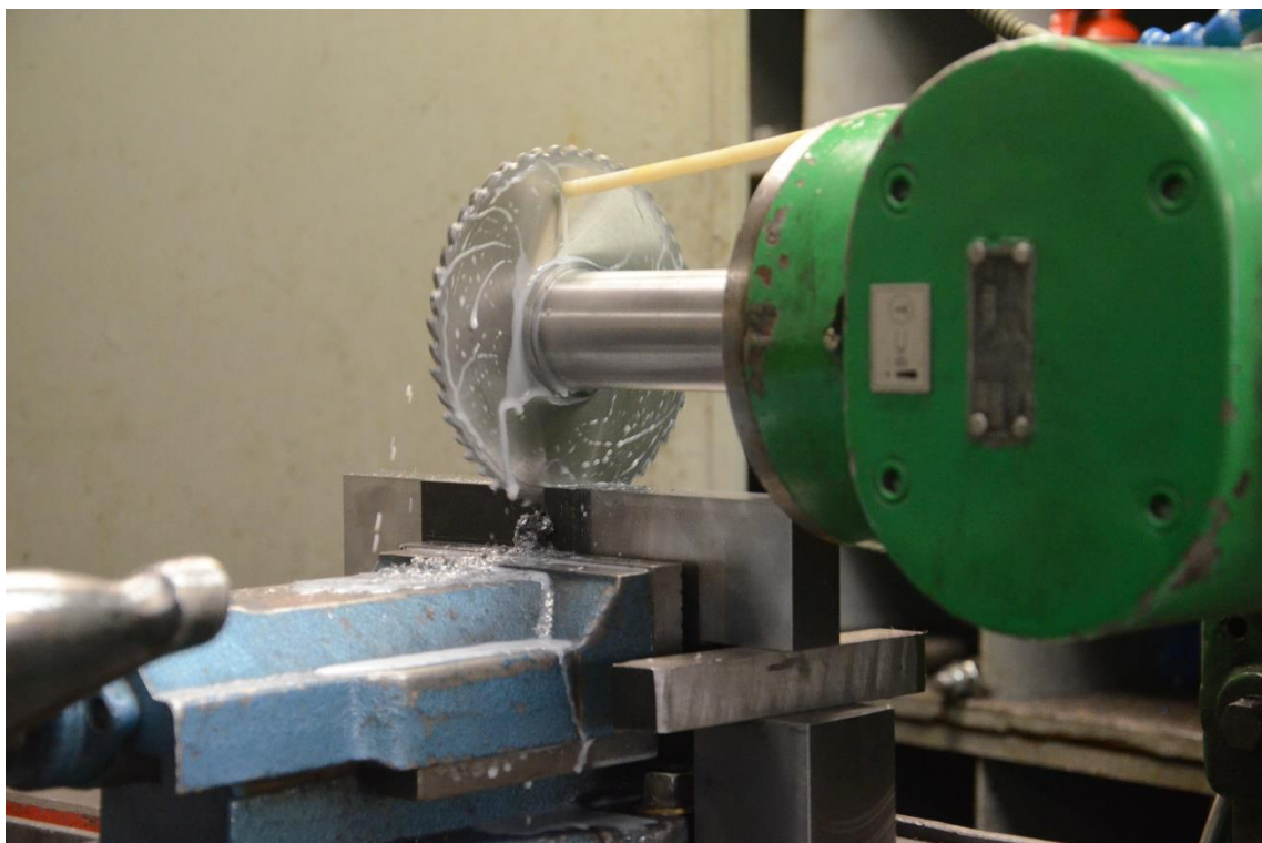
Rys. 10.7 Nacinanie karbów frezem piłkowym
