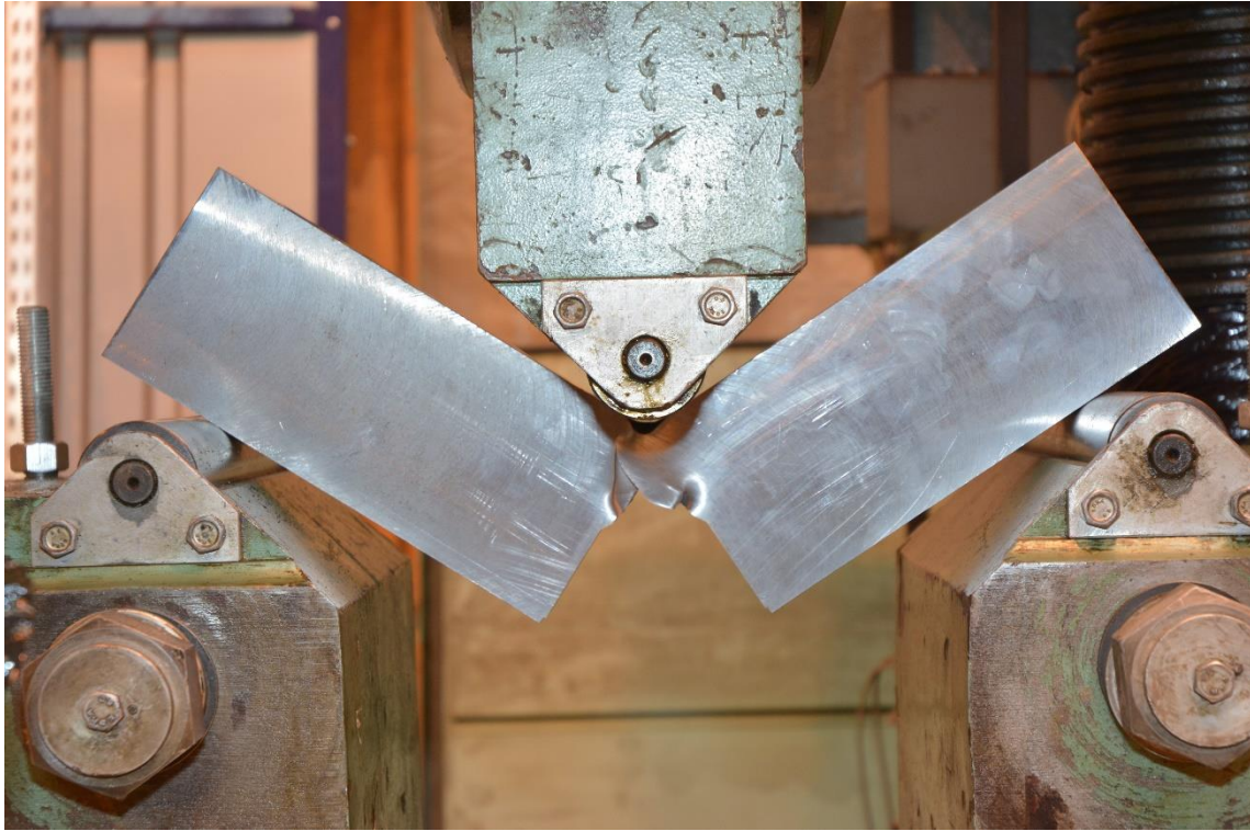
Rys. 10.14 Próbkę z serii B60 w trakcie dołamywania
