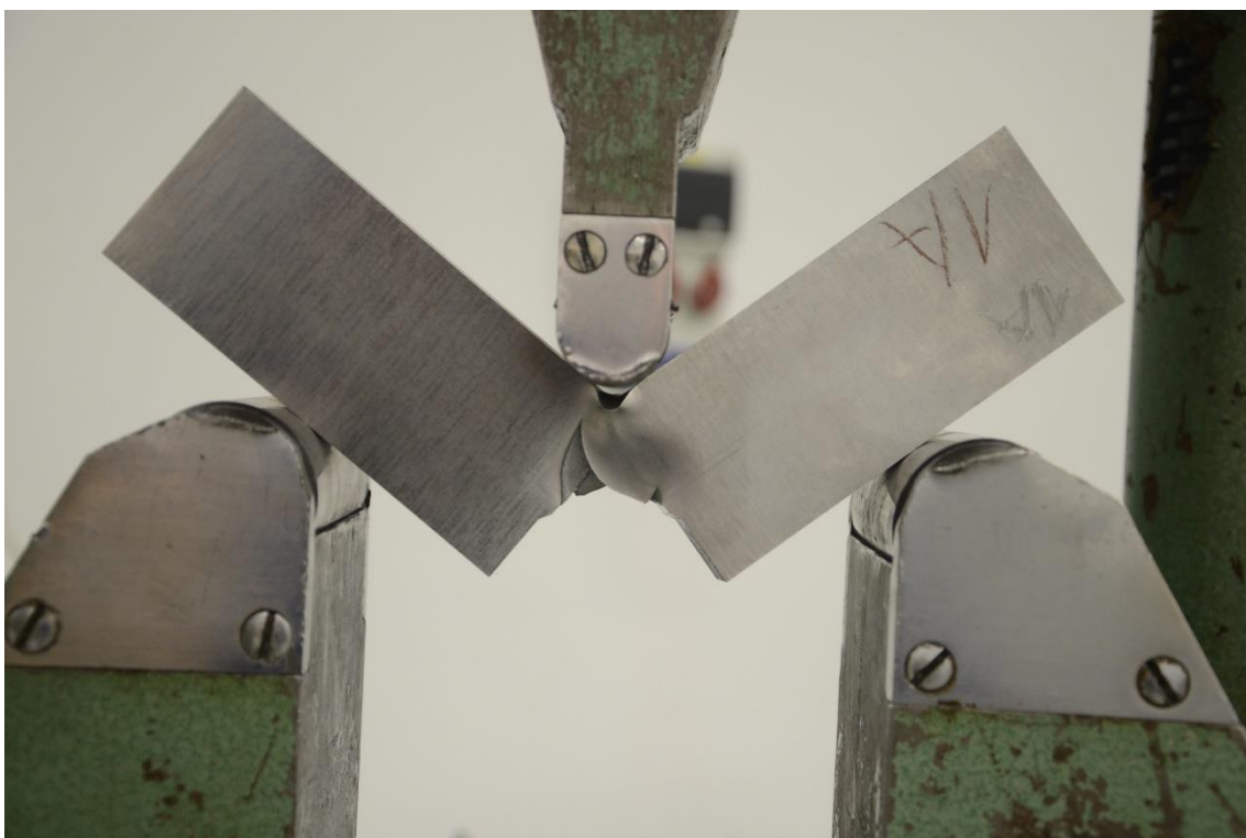
Rys. 10.13 Próbka z serii B30 w trakcie dołamywania
