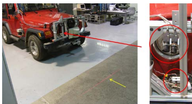
Fot. 1. Pojazd wyposażony w czujnik światła strukturalnego i kamerę. Żółtą linią zaznaczony emitowany wzorzec [2]
