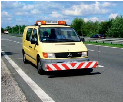
Fot. 2. Wykorzystywany przez GDDKiA profilograf laserowy [6]
