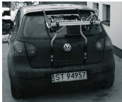
Fot. 3. Sposób montażu systemu stereowizyjnego [7]
