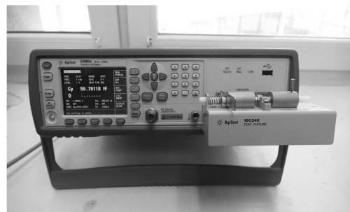
Rys. 2. Dokładny miernik LCR E4980A firmy Agilent
