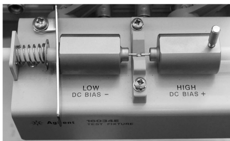
Rys. 3. Adapter typu 16034E, do pomiaru elementów SMD
