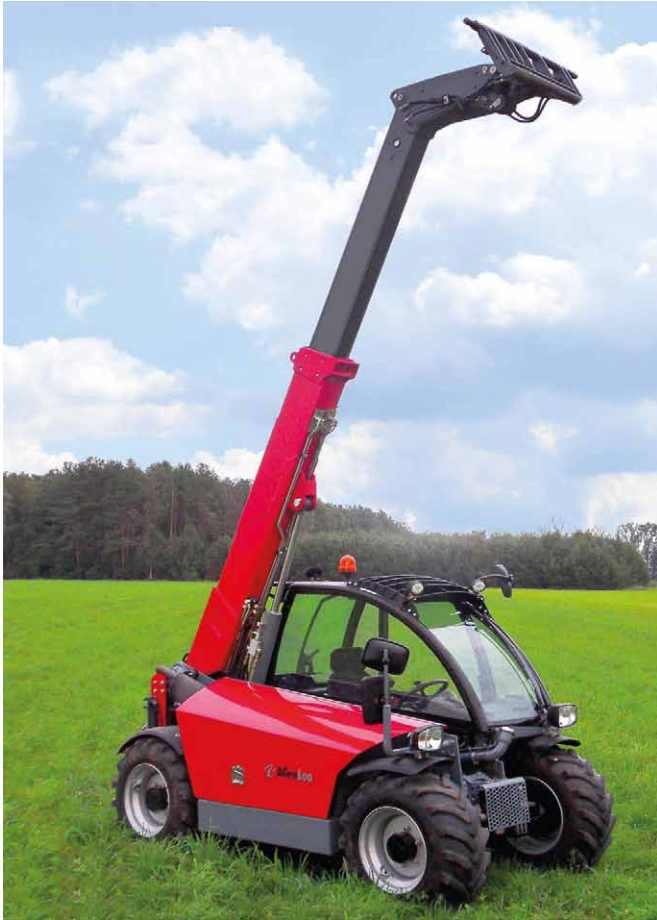
Rys. 1. Ładowarka teleskopowa „AGroLeo” [1]
