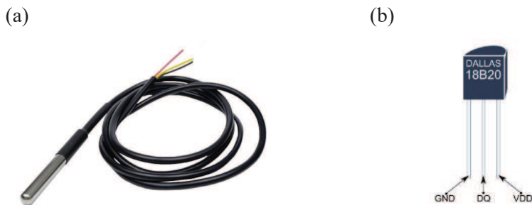
Rys. 4.5. (a) Wodoodporny czujnik pomiaru temperatury 1-wire, (b) Budowa czujnika DS18B20
