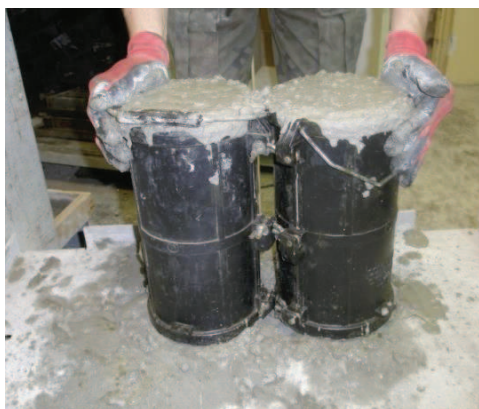
Rys. 4.2. (a) Zagęszczanie próbek na stoliku wibracyjnym, (b) Zaformowane próbki walcowe
