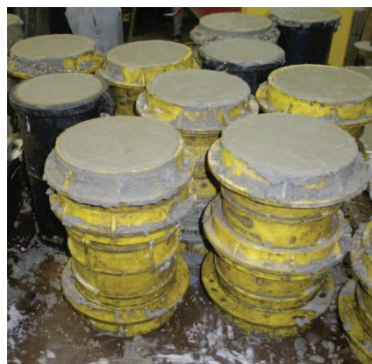
Rys. 4.2. (a) Zagęszczanie próbek na stoliku wibracyjnym, (b) Zaformowane próbki walcowe
