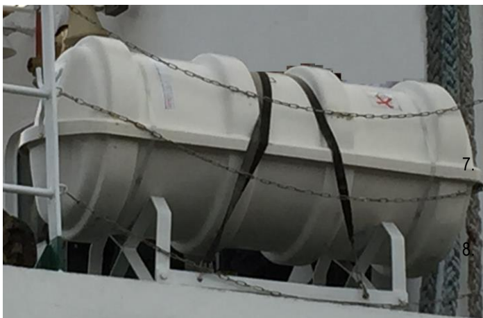
Rys. 4. Tratwa ratunkowa spakowana w kontenerze i umieszczona na pokładzie statku.
