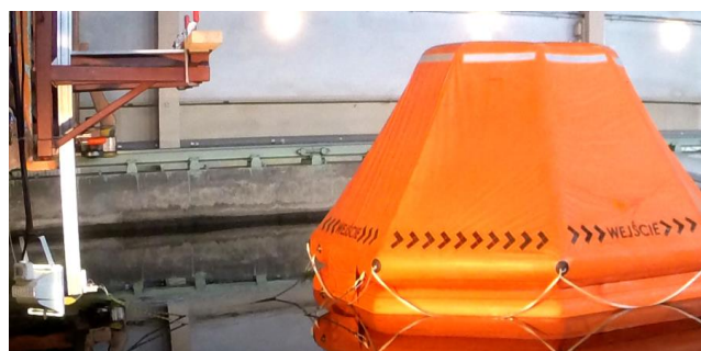
Rys. 5. Tratwa podczas holowania na basenie modelowym CTO [7]
