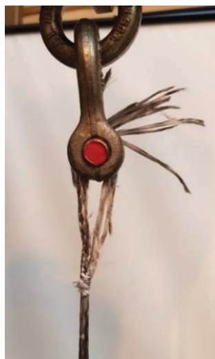
Rys. 10. Próbką po rozpleceniu
