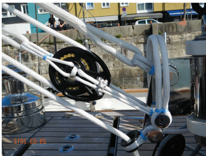
Rys. 4. Konstrukcja talii obciążacza bomu
