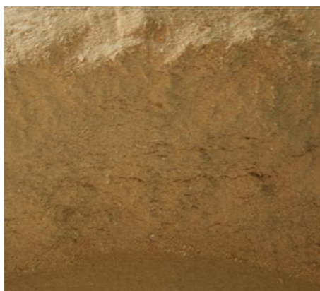
Rysunek 6.12 Wióry bukowe z zawartością pyłu i drobnych cząstek styropianu.
