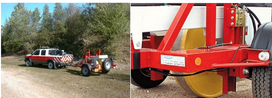
Rysunek 3.9 Sprzęt do badań portancemetrem (VECTRA France, 2016)
