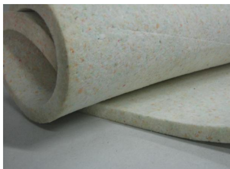
Rysunek 6.8 Pianka poliuretanowa wtórnie spieniona.
