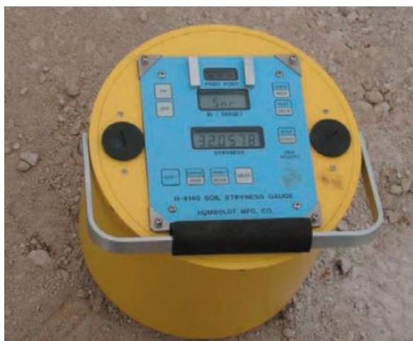
Rysunek 3.7 Aparat SSG (McLawnhorn, 2006)
