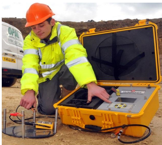
Rysunek 3.6 Aparat EDG (Opal Testing, 2016)
