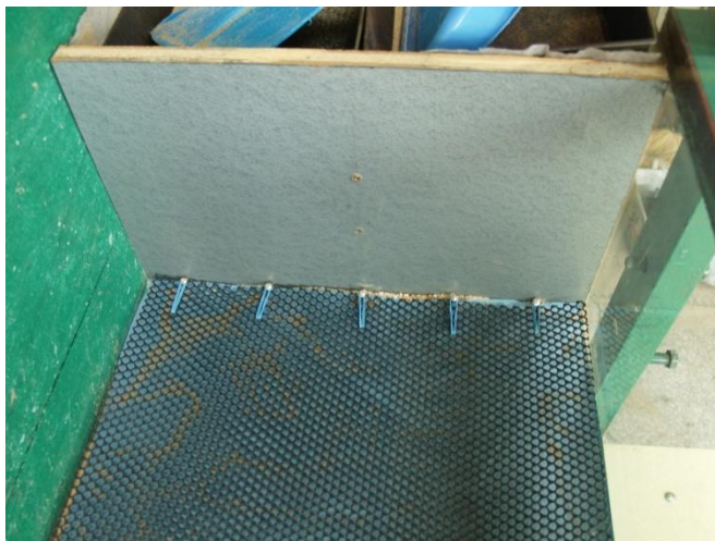
Rysunek 6.23 Widok kotwienia z wnętrza stanowiska
