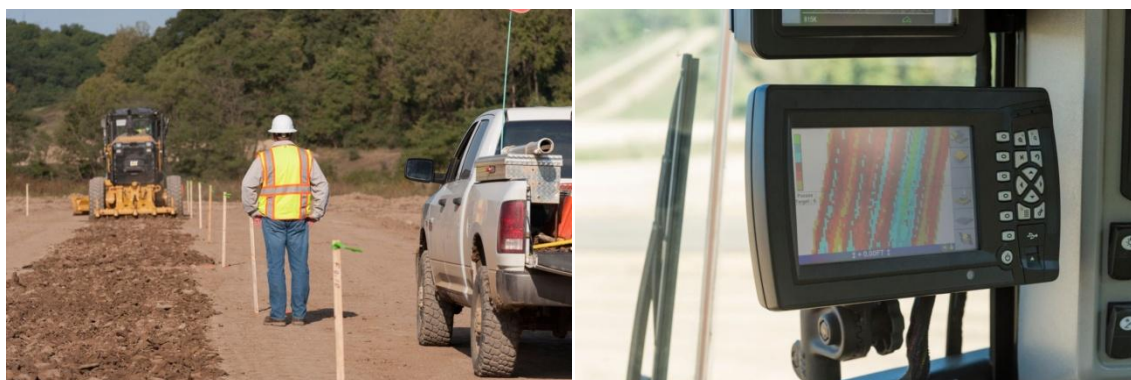
Rysunek 3.8 Walec oraz panel sterowania w metodzie inteligentnego zagęszczania (Caterpillar, 2016)
