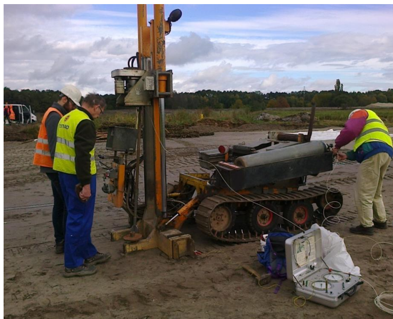
Rysunek 7.1 Badania dylatometryczne na platformie roboczej
