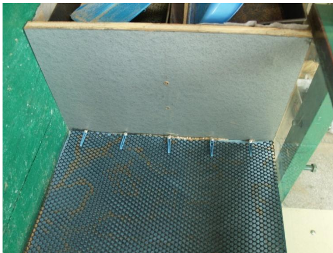
Rysunek 6.23 Widok kotwienia z wnętrza stanowiska
