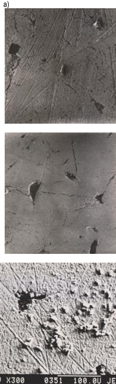
Rys. 11. Przykłady skażenia powierzchni przy niewłaściwym myciu elementów po docieraniu: a) element z żeliwa EN-GJN-250, b) element z żeliwa EN-GJS-600-3
