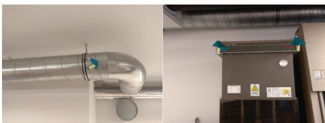
Rys. 3. Rozmieszczenie próbników pasywnych służących do pobierania próbek analitów z grupy LZO z fazy gazowej podczas wyznaczania optymalnego czasu wulkanizacji dla modyfikowanych regeneratów gumowych
