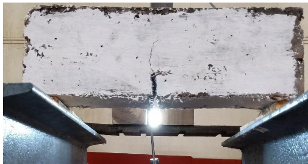
Fig. 4 Mode-I fracture test setup
