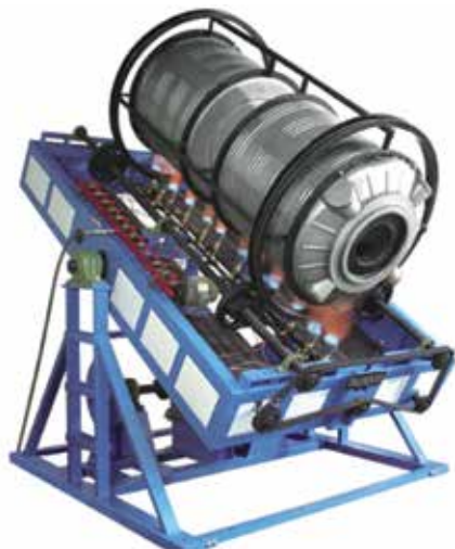
Rys. 6. Maszyna do odlewania rotacyjnego typu kotłowskiego [2]
