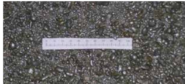
Rys. 6. Uzyskany granulaty o kształcie zbliżonym do globularnego
