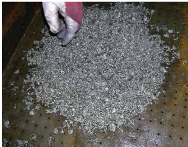
Rys. 9. Granulat staliwa GXCrNiMo18-10-2 uzyskany w wyniku zastosowania ceramicznego filtra odlewniczego
