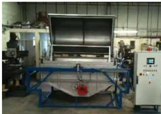
Rys. 5. Maszyna do odlewania rotacyjnego typu skorupowego [4]
