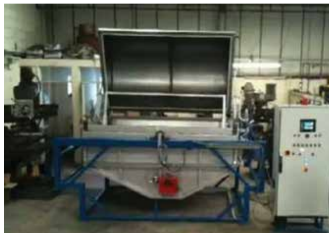
Rys. 5. Maszyna do odlewania rotacyjnego typu skorupowego [4]
