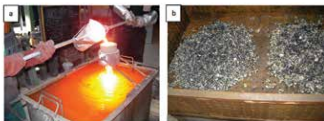
Rys. 2. Proces przelewania ciekłego metalu z większej jednostki piecowej przez filtr (a) oraz uzyskany granulat (b)
