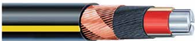
Rys. 7. Widok kabla o trzech żyłach aluminiowych o izolacji z kauczuku etylenowo-propylenowego (EPR), oplecionych drutami miedzianymi, jako żyły ochronno-neutralnej. Źródło: [10]
