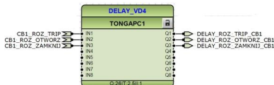
Rys. 6. Funkcja TONGAPC1 realizująca opóźnienie sygnałów sterujących wyłącznikiem [3]
