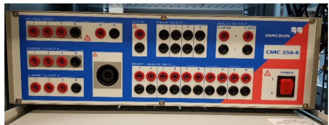
Rys. 4. Tester zabezpieczeń CMC 256-6
