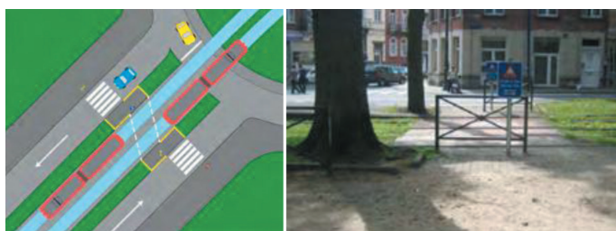
Rys. 5. Przykład geometrii przejścia „Z-crossing” (a – z lewej) oraz zastosowania barierki ochronnej przy przejściu przez torowisko (b – z prawej)
