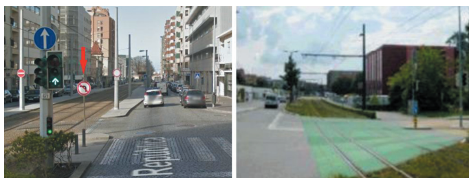
Rys. 4. Przykład ograniczenia manewru skrótu w lewo w Porto (a – z lewej) oraz wyznaczenia obszaru torowiska kolorem zielonym w Zurichu (b – z prawej)
