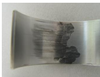
Rys. 2. Uszkodzenie zmęczeniowe badanej panwi MB52 [9]
