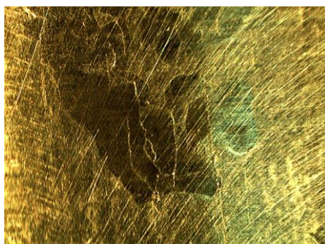
Rys. 13. Obraz pęknięć zmęczeniowych na powierzchni panwi z materiału MB50 (powiększenie 10×) [9]
