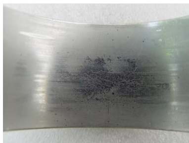
Rys. 4. Uszkodzenie zmęczeniowe badanej panwi MB40 [9]
