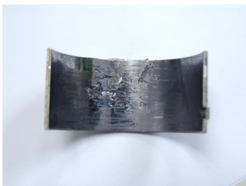
Rys. 8. Siatka pęknięć na powłoce ślizgowej panwi z materiału MB02 wyjętej z obudowy łożyska po badaniach zmęczeniowych [9]
