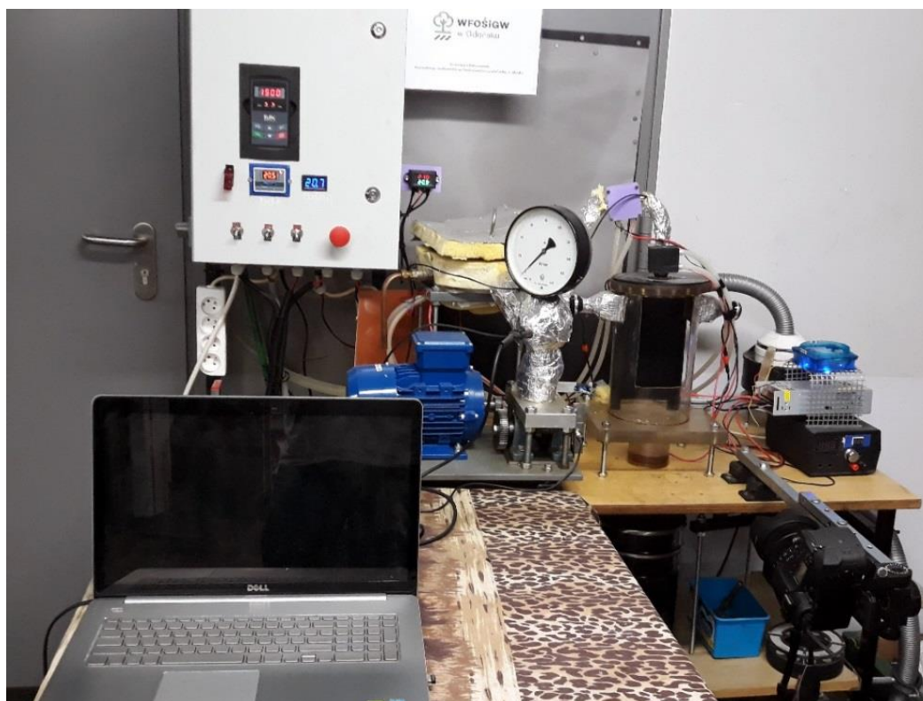
Rys. 2. Widok stanowiska do badania strugi rozpylanego paliwa.
