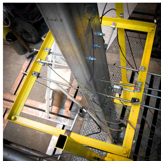
Rys. 6.6. Zdjęcia przedstawiające sposób montażu czujników mechanicznych: a) poziom 1, b) poziom 3.
