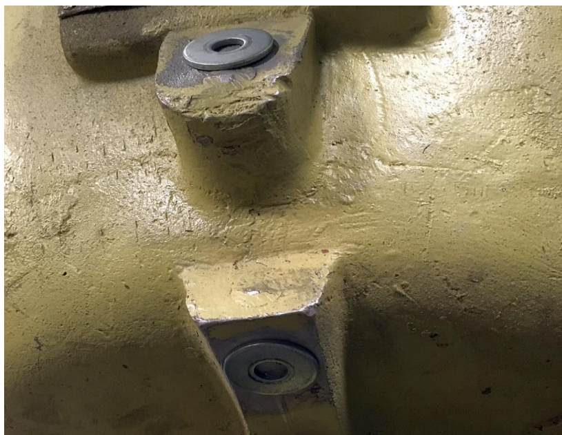
Rys. 3. Sposób przygotowania punktów pomiaru drgań w płaszczyznach pionowej i poziomej na amagnetycznej (aluminiowej) obudowie przekładni redukcyjnej silnika Zvezda M520 - poprzez przyklejenie stalowych podkładek
