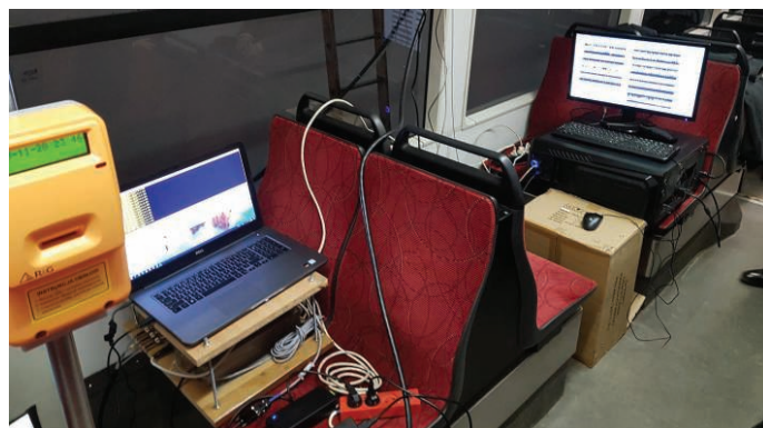
10. Kontrolery systemu akcelerometrów i inklinometru oraz kompasu GNSS
