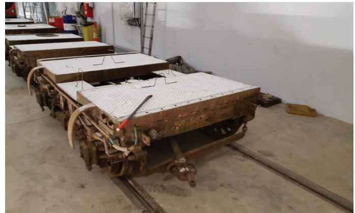
6. Wózki wagonu GWF serii 300 wykorzystane jako pojazdy pomiarowe
