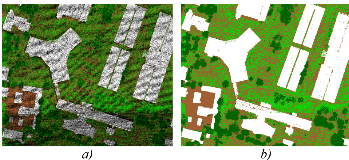
Rys. 38. Dwa różne rezultaty przetworzenia pojedynczego zbioru danych do postaci rastrów o rozdzielczościach 0,25\text{ m} \times 0,25\text{ m} (a) oraz 0,5\text{ m} \times 0,5\text{ m} (b)
