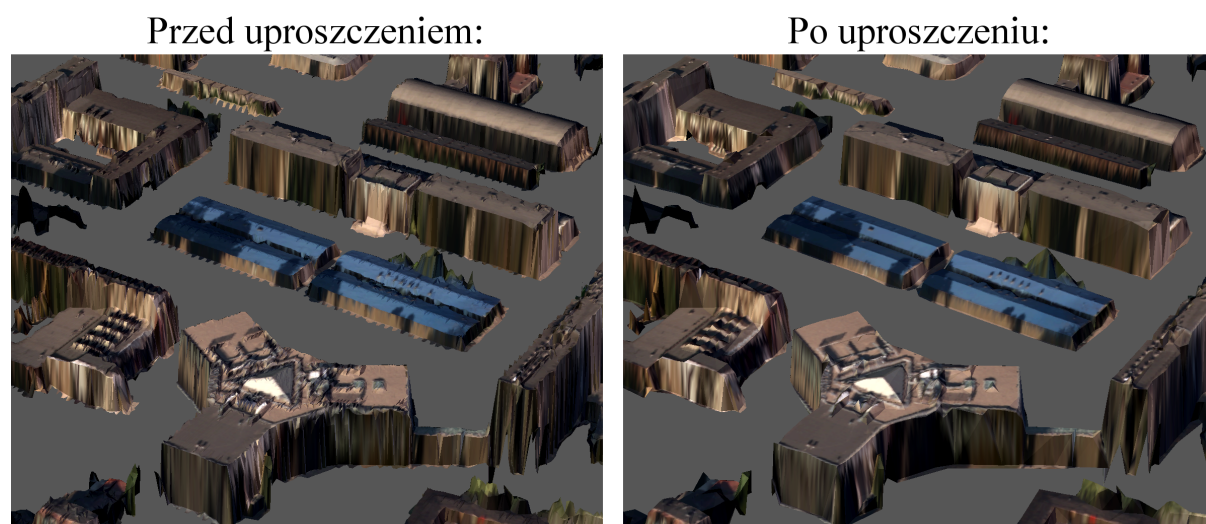
Rys. 78. Modele budynków kampusu Politechniki Gdańskiej przed i po uproszczeniu (z zastosowaniem dziesięciokrotnej redukcji liczby trójkątów)
