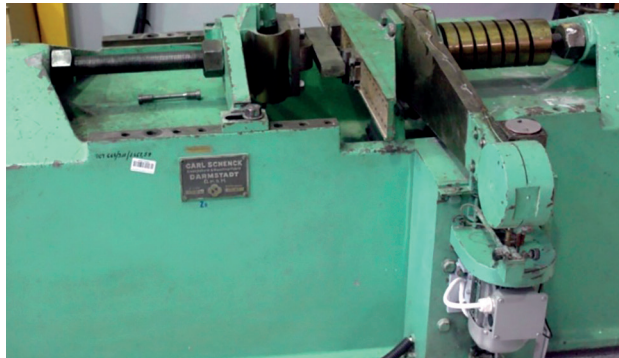
Rys. 2.12. Dynamiczna maszyna wytrzymałościowa do badań zmęczeniowych SCHENCK
