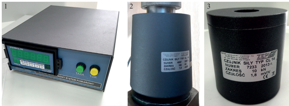
Rys. 2.17. Cyfrowy zestaw do pomiaru siły ZEPWN: 1 – miernik mikroprocesorowy CL 361A, 2 – czujnik siły CL 14 o zakresie \pm 100 kN, 3 – czujnik siły CL 14 o zakresie \pm 10 kN
