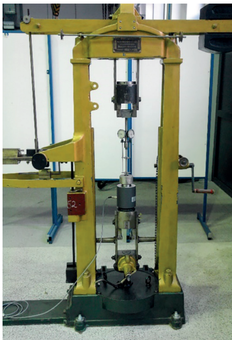
Rys. 2.8. Maszyna wytrzymałościowa typu wagowego LOSENHAUSEN (50 kN)
