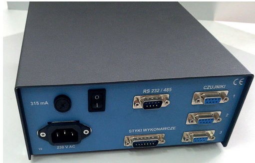
Rys. 2.16. Cyfrowy zestaw do pomiarów tensometrycznych CL 363 (ZEPWN)
