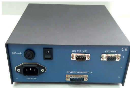
Rys. 2.18. Cyfrowy zestaw do pomiarów temperatury CL 323 ZEPWN (zakres I: 0 \div 600^\circ\text{C} ; zakres II: -150 \div 50^\circ\text{C} )
