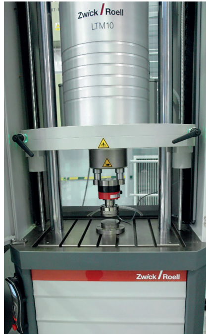
Rys. 2.6. Maszyna wytrzymałościowa do badań zmęczeniowych ZWICK LTM10 (10 kN)
