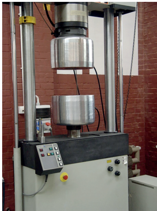
Rys. 2.7. Maszyna wytrzymałościowa INSTRON 8503 (500 kN)
