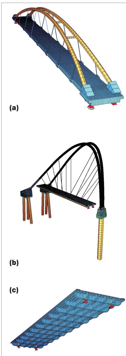
Rys. 5. Modele MES kładki (a) nad drogą S8 (b) nad Trasą Uniwersytecką w Bydgoszczy (c) nad ulicą Chwarznieńską w Gdyni
