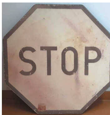
Fot. 3. Znak B-20 po 9 latach eksploatacji
