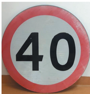
Fot. 2. Znak B-33 po 9 latach eksploatacji
