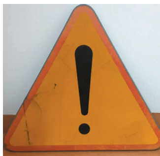
Fot. 4. Znak B-20 po 9 latach eksploatacji
