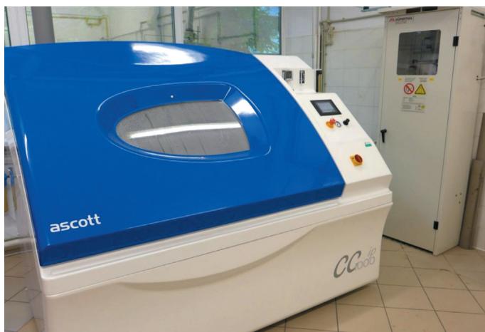
Fot. 7. Komora korozyjna Ascott CP1000IP
