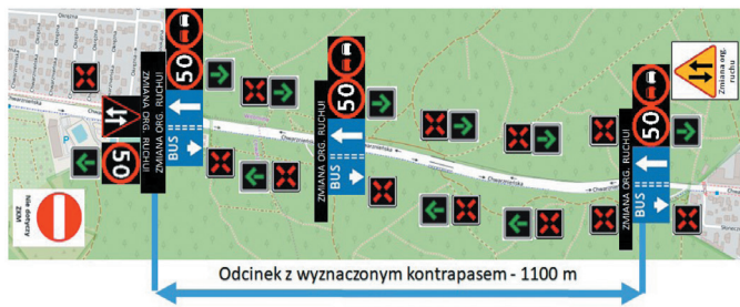
Rys. 4. Schemat scenariusza organizacji ruchu z uruchomionym kontrapasem autobusowym Źródło: opracowanie własne na podstawie materiałów ZDiZ Gdynia i openstreetmap.org
