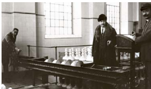
Rys. 12. Próbné rozciąganie łańcucha czterech izolatorów typu Hf 35 za pomocą 20 tonowego dynamometru pod nadzorem Alfonsa Hoffmanna [11]
