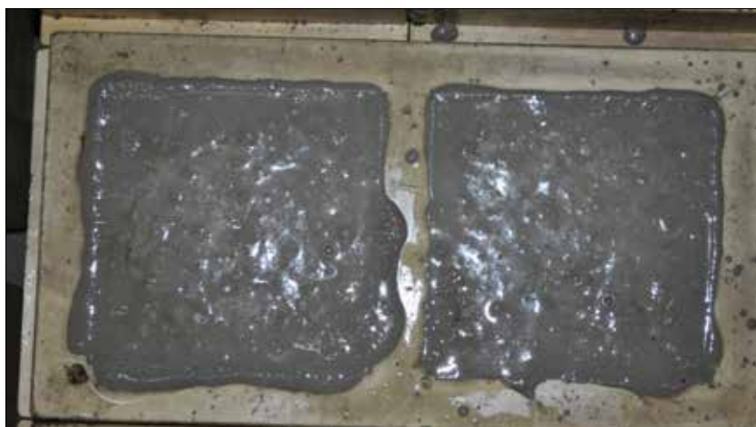
Fot. 7. Próbkę zarobów próbnych, na powierzchni próbek widoczny zaczyn cementowy (bleeding)
