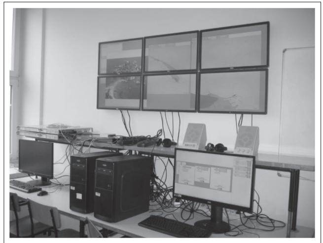
■ Rys. 3. Stanowisko SWZ z widocznymi monitorem zarządzania i wieloekranem [11]
