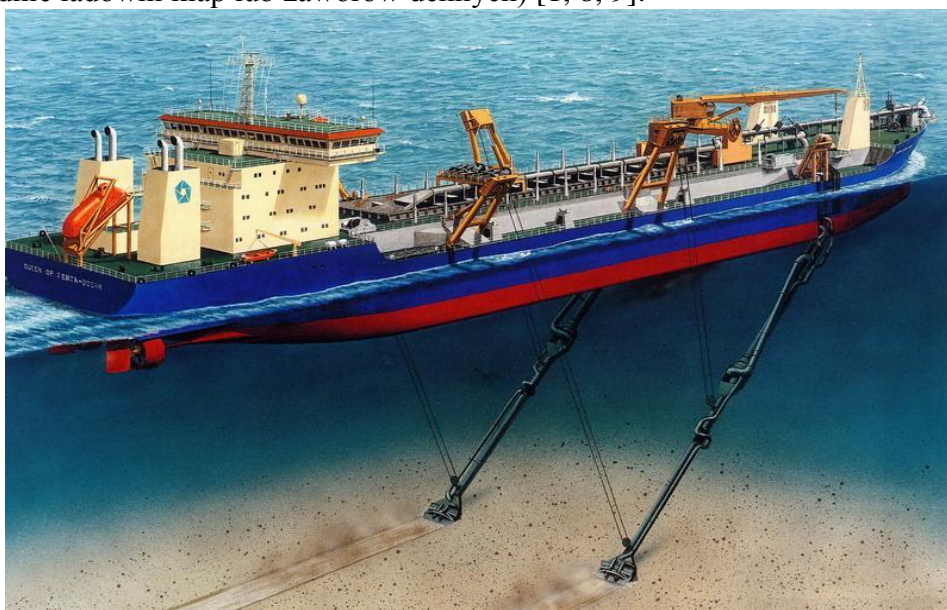
Rys. 1. Widok pogłębiarki ssącej nasiębiernej podczas załadunku
