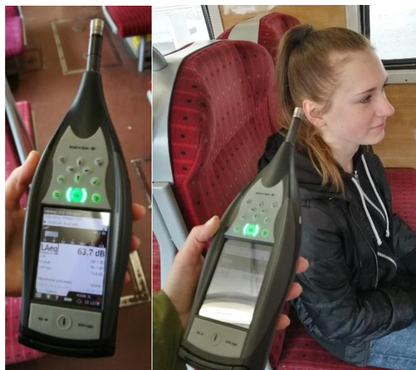
Rys. 5. Miernik poziomu dźwięku B&K 2250Light [opracowanie własne]
