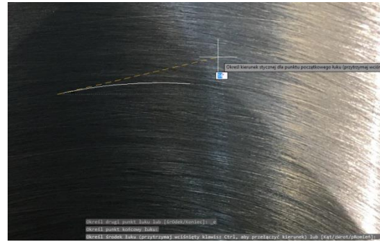
Rys. 15 Uzyskana tekstura powierzchni gładzonej „VH” dla zmiennej prędkości skoku F1000 – F3000 (nachylenie stycznej do kanału olejowego 15° względem wektora prędkości Vaz)
