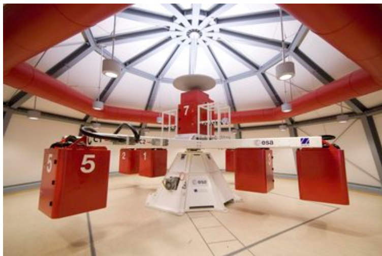
Rys. 1. Wirówka odśrodkowa Large Diameter Centrifuge.
