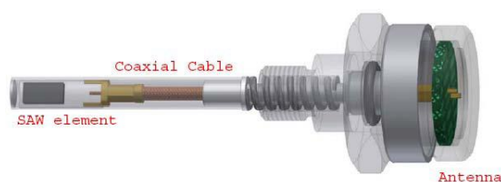
Rys. 3. Widok bezprzewodowego czujnika przeznaczonego do pomiaru temperatury [10]
