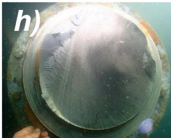
Rys. 1. Uszkodzenia zmęczeniowe wałów napędowych statków:
