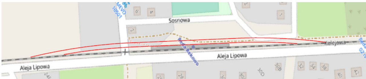
Fig. 3. Proposed location of a staggered track at the Reda Rekowo stop (own elaboration) Rys. 3. Proponowana lokalizacji mijanki na przystanku Reda Rekowo (opracowanie własne)
