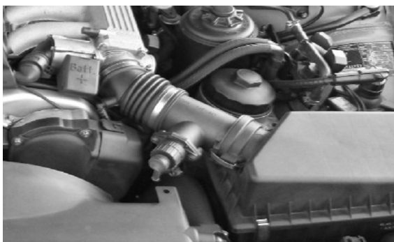
Rys. 1. Lokalizację przepływomierza powietrza w silniku wolnossącym M70 produkcji BMW (fot. autorów)
