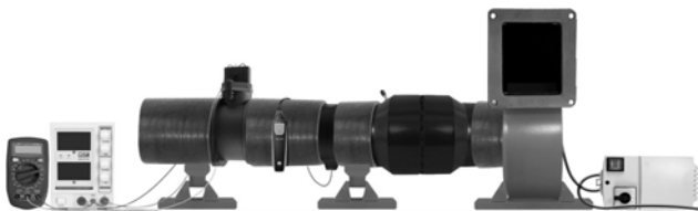
Rys. 5. Stanowisko badawcze dla przepływomierza z klapą sięprzającą, HLM, HFM oraz Vortex
