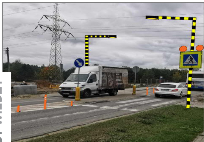
13. Schemat proponowanych zmian poprawy widoczności w obrębie przejścia dla pieszych na ul. Kartuskiej
