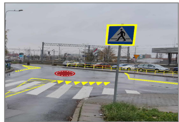
Rys. 13. Schemat proponowanych zmian w obrębie przejścia dla pieszych na ul. Lenziona
