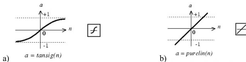
Rys.45 Funkcje aktywacji sieci, a) warstwa 1: f. tangensoidalna, b) warstwa 2: f. liniowa
