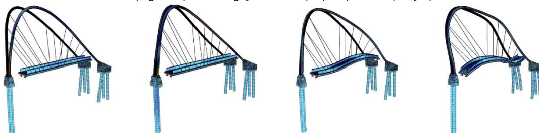
Rysunek 6.23 Zestawienie pomierzonych i numerycznych częstotliwości drgań kładki nad ul. Ogińskiego w Bydgoszczy bez uwzględnienia współpracy barieroporęczy
