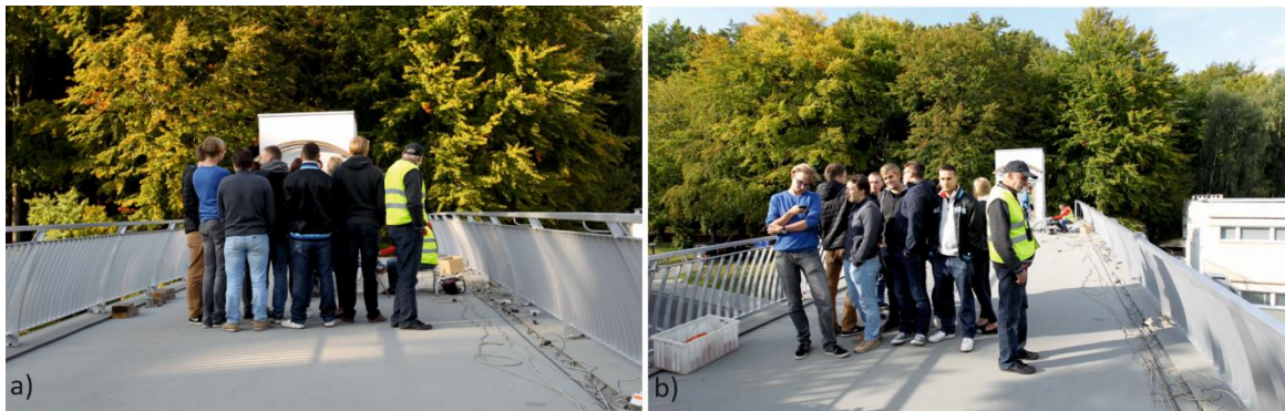
Rysunek 6.46 Położenie masy skupionej złożonej z grupy 11 osób na obiekcie w polu a) 3 (C-D) b) 5 (E-F)
