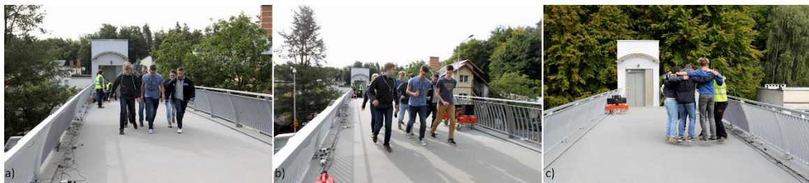
Rysunek 6.1 Metody wzbudzenia dynamicznego kładek dla pieszych a) marsz b) bieg c) podskoki
