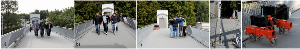
Rysunek 6.45 Testy dynamiczne przeprowadzone na kładce nad ulicą Chwarznieńską a) marsz synchroniczny b) bieg synchroniczny c) podskoki d) wymuszenie małym wzbudnikiem drgań e) wymuszenie dużym wzbudnikiem drgań
