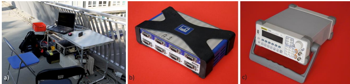
Rysunek 6.5 a) Stanowisko pomiarowe b) System akwizycji danych Quantum 840a c) generator RIGOL DG1022
