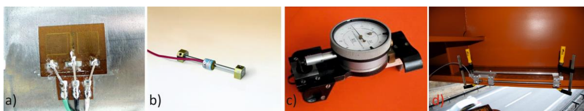
Rysunek 1.5 Czujniki do pomiaru odkształceń a) tensometr elektrooporowy b) tensometr strunowy (źródło: Neostrein) c) ekstensometry mechaniczny d) ekstensometry indukcyjny
