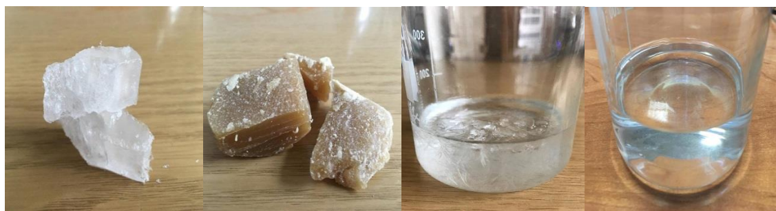
Rysunek 13. Wygląd zastosowanych organicznych PCM w temperaturze pokojowej, od lewej: parafina o t.t. 42 – 44°C, Cerezyzna, Rubitherm RT22, parafina C 14 -C 17
