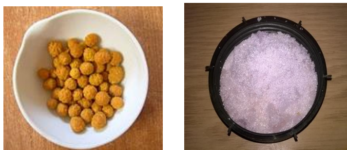
Rysunek 14. Wygląd zastosowanych nieorganicznych PCM w temperaturze pokojowej, od lewej: chlorek żelaza (III) sześciowodny, siarczan amonu żelaza (III) dwunastowodny
