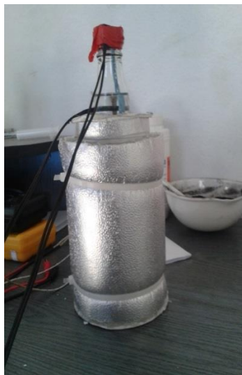
Rysunek 64. Pojemnik, skonstruowany do wstępnych badań możliwości utrzymania obniżonej temperatury napojów
