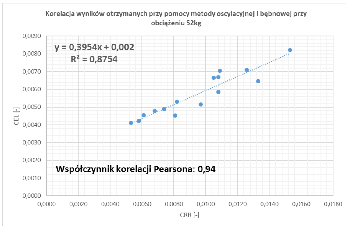
Rysunek 72. Korelacja wyników otrzymanych przy pomocy metody oscylacyjnej i bębnowej (przy obciążeniu 52kg dla metody oscylacyjnej i 408kg dla metody bębnowej)
