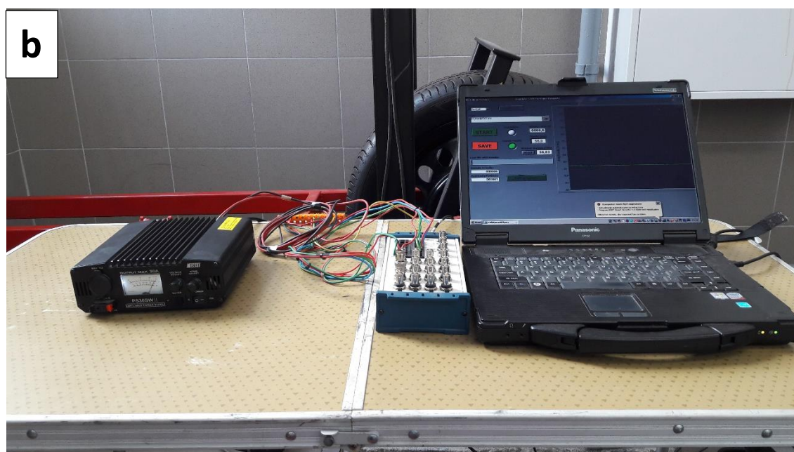
Rysunek 47. Laserowy czujnik położenia ILD 1401-50 przymocowany do stanowiska (a); kasetka pomiarowa NI USB-6216 BNC wraz z komputerem obsługującym program rejestrujący przebieg odbicia badanej opony (b); zrzut z ekranu komputera przedstawiający interfejs programu (program napisany przez dr hab. inż. Grzegorza Ronowskiego prof. nadzw. PG)(c)
