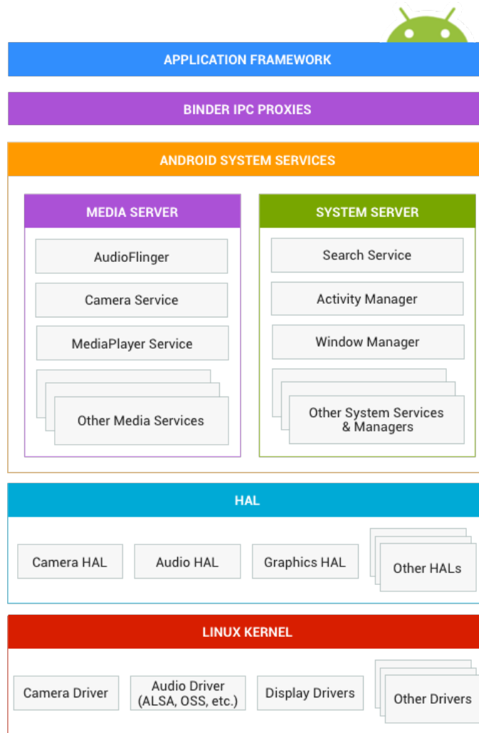
Rysunek 2.3: Architektura systemu Android. Źródło: http://www.android.com
