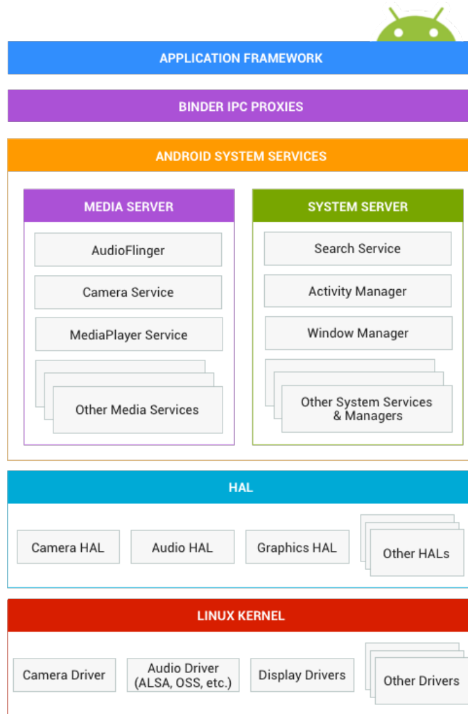
Rysunek 2.3: Architektura systemu Android. Źródło: http://www.android.com
