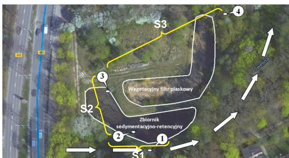
Rys. 3.4. Zdjęcie satelitarne obiektu hydrofitowego na potoku Swelina; 1, 2, 3, 4 punkty poboru próbek; S1, S2, S3 – stopnie oczyszczania ( http://www.mapa-google.pl )
