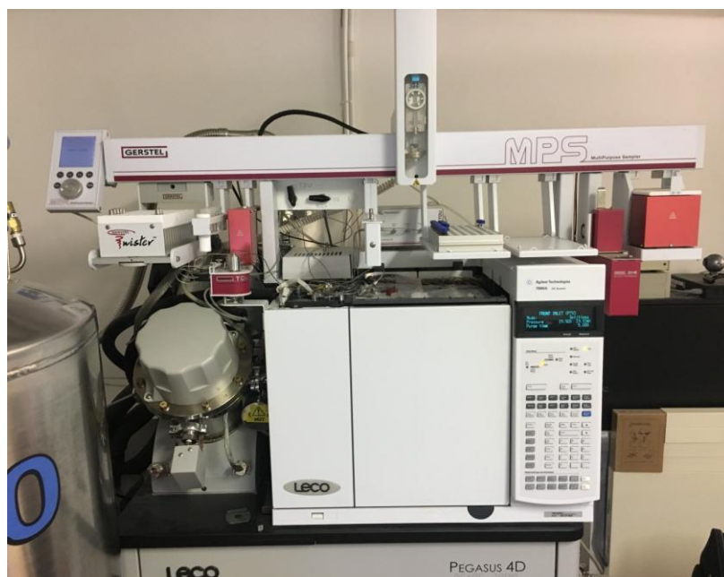
Rysunek 13 Widok ogólny zestawu GC×GC-TOF-MS firmy LECO
