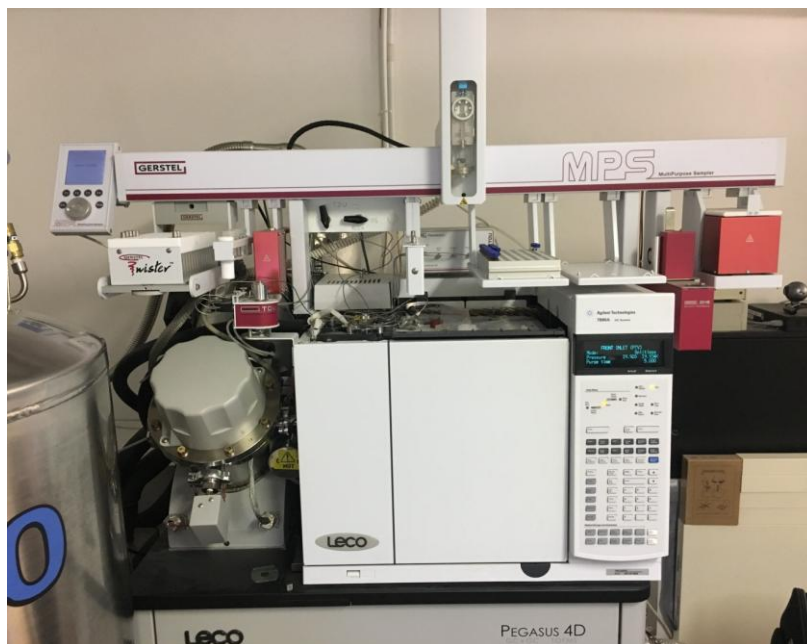
Rysunek 13 Widok ogólny zestawu GC×GC-TOF-MS firmy LECO
