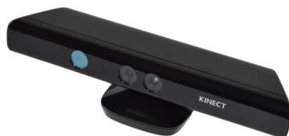
Rysunek 4.8. Kamera Kinect wykorzystana do wykrywania pozycji ciała osób badanych
