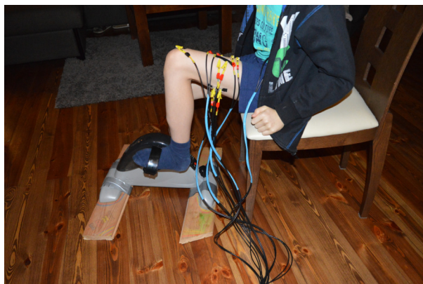
Rysunek 5.18. Badanie aktywności mięśni nóg podczas ćwiczeń na rotorze rehabilitacyjnym
