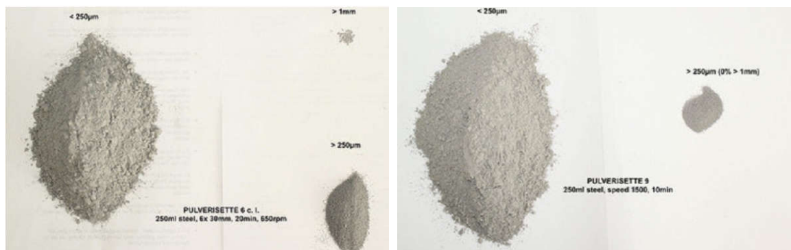
Rysunek 20 Fragmenty modułu po zmieleniu w młynach firmy Fritsch
