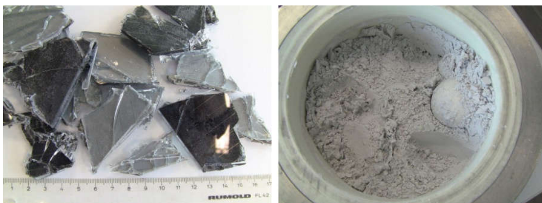
Rysunek 19 Fragmenty modułu po zmieleniu w młynie firmy Retsch
