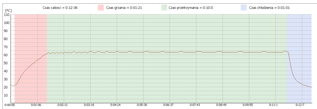
Rysunek 17. Wykres temperaturowy ogrzewania mikrofalowego sporządzony przy wykorzystaniu oprogramowania załączonego do prototypu pasteryzatora mikrofalowego skonstruowanego przez firmę Enbio Technology Sp. z o. o. ■ - czas uzyskania temp. 62,5°C, ■ - czas chłodzenia do temp. 20°C
