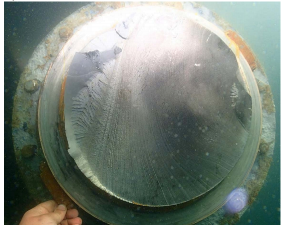
Rys. 2.1. Uszkodzenia zmęczeniowe wałów napędowych statków:
